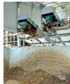
牛房に付けられた緩やかな傾斜とベルトコンベアにより、糞は自動で集積される。集めた糞は乾燥させ、完熟堆肥として地元農家などに還元。無駄のない循環型システムを確立している
